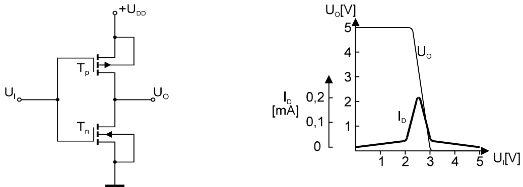
Rys. 4.5. Inwerter CMOS i jego charakterystyka przejściowa
